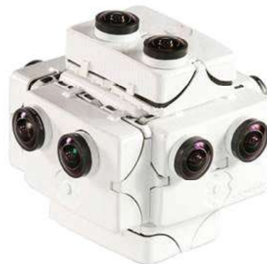
Панорамная камера, которую SpaceVR планировала отправить на МКС. Судя по расположению объективов, панорамная трансляция предполагалась в формате стереопары
